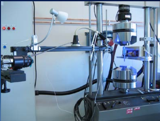
Experimentuppställning, dragprovning med induktiv uppvärmning
